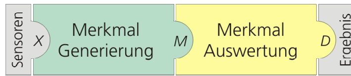
Bild 2: Technische Diagnose als zweistufiger logischer Entscheidungsprozess
